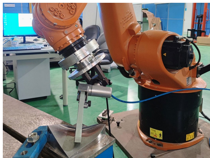
图7 机器人磨抛试验
